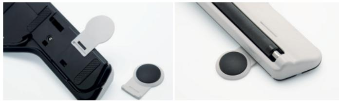
**Controllo del cursore** – Individuare la rollerbar. La rollerbar è una barra gommata di colore grigio ed è la parte del RollerMouse che si trova più vicino alla tastiera. Provare a far ruotare la barra verso l'alto e verso il basso e osservare il movimento del puntatore, quindi ripetere l'azione verso destra e verso sinistra. Una volta presa un po' di familiarità con lo strumento, si può procedere a un semplice test muovendo il puntatore per scrivere idealmente il proprio nome sullo schermo.
